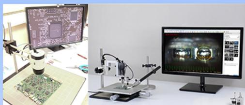
Contrôle optique par camera vidéo
