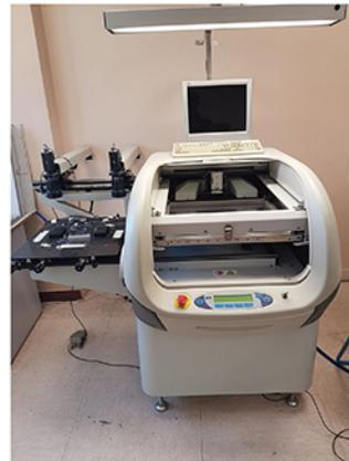
La sérigraphie consiste à déposer de la pâte à braser sur toutes les surfaces recevant des pattes de composants. Pour cela, il est nécessaire d'utiliser un masque de sérigraphie réalisé en sous-traitance.
