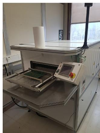
La soudure des composants est réalisée par passage dans un four. Les cartes électroniques sont déposées sur un panier support. L'ensemble est plongé dans la vapeur qui se condense sur le PCB et transfère sa chaleur.
