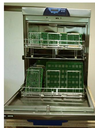
Tout au long de la chaîne de câblage les cartes sont en contacts avec de nombreux contaminants. Certains contaminants sont isolants et empêchent le contact électrique ce qui génère des défauts. D'autres contaminants entraînent des pertes d'isolement pouvant générer des erreurs sur des signaux critiques.
