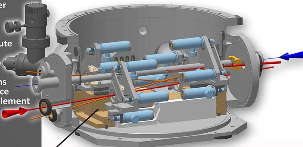
Dessin de la cavité quatre miroirs montrant les principaux éléments mécaniques. Le laser est en orange, le faisceau en bleu et les photons en rouge. Le développement de cette cavité au LAL a occupé une bonne partie de la période 2008-2010. Il a fallu mettre au point un système mécanique compatible avec l'ultra-vide de l'anneau ATF tout en gardant la flexibilité requise pour un ajustement fin de la position des miroirs dans la cavité.
