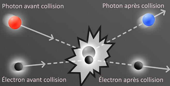
Lors d'une interaction Compton dans MightyLaser, un électron transfère une partie de son énergie à un photon peu énergétique du laser infrarouge ; ce photon devient alors un rayon gamma de haute énergie.
