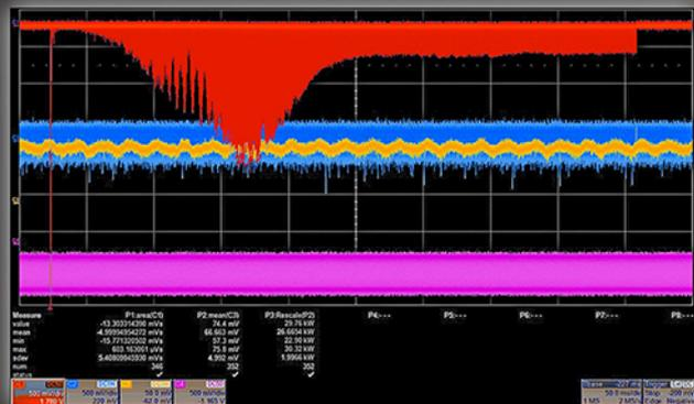
En rouge : rayons gamma observés dans le calorimètre de MightyLaser dus aux interactions entre les photons du laser et les électrons de l'anneau de stockage ATF.
